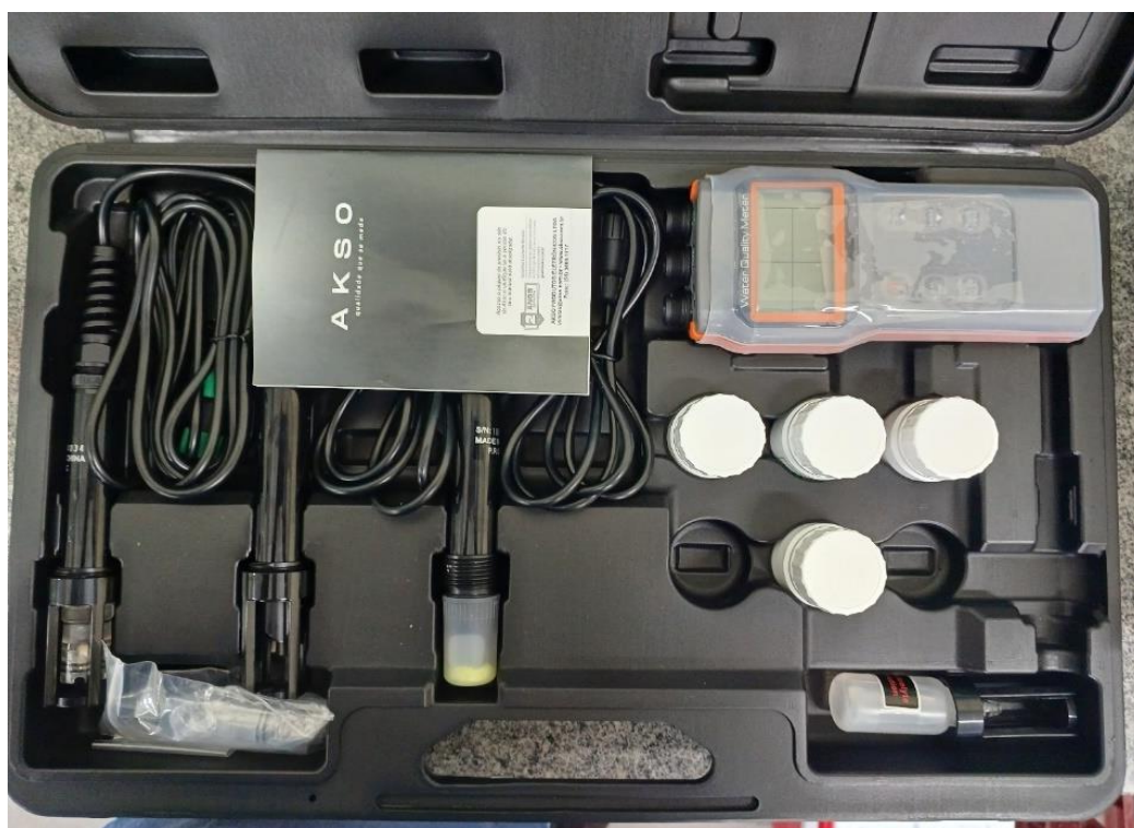
Figura 45 – Modelo de sonda multiparamétrica utilizada no monitoramento.
